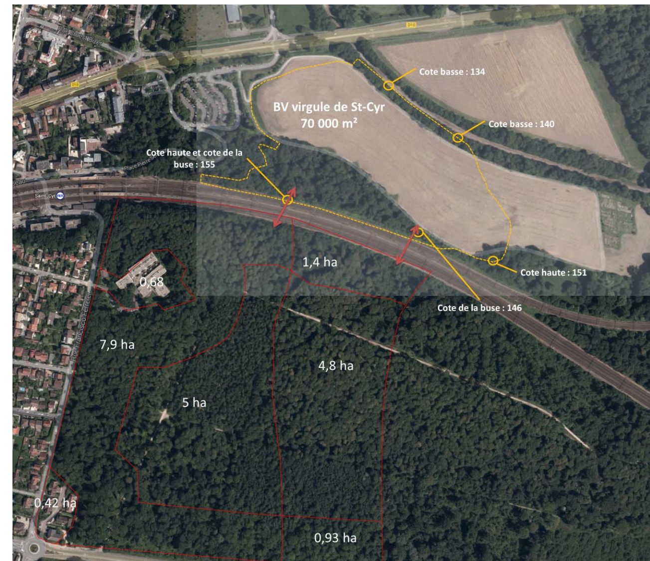
Figure 78 : Localisation indicative des bassins versants naturels situés en amont du RFN et du BVN de la virgule de Saint-Cyr (source MOE SNCF pour RFF)
